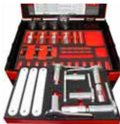
Kit necessario per sostenere e bloccare organi meccanici e pacco batteria. Ideale per gruppo trasmissione/cambio, motore e gruppo sospensioni.
